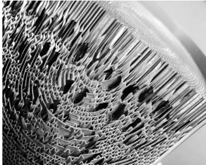
Fig. 5 PE structure with “caverns”
