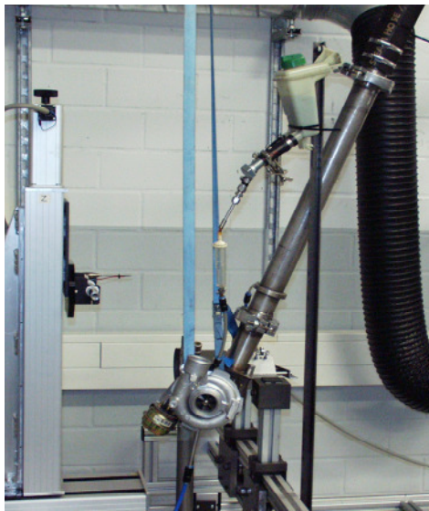
Abbildung 17: Versuchsaufbau zur Messung der Strömungsverteilung im Original Canning
