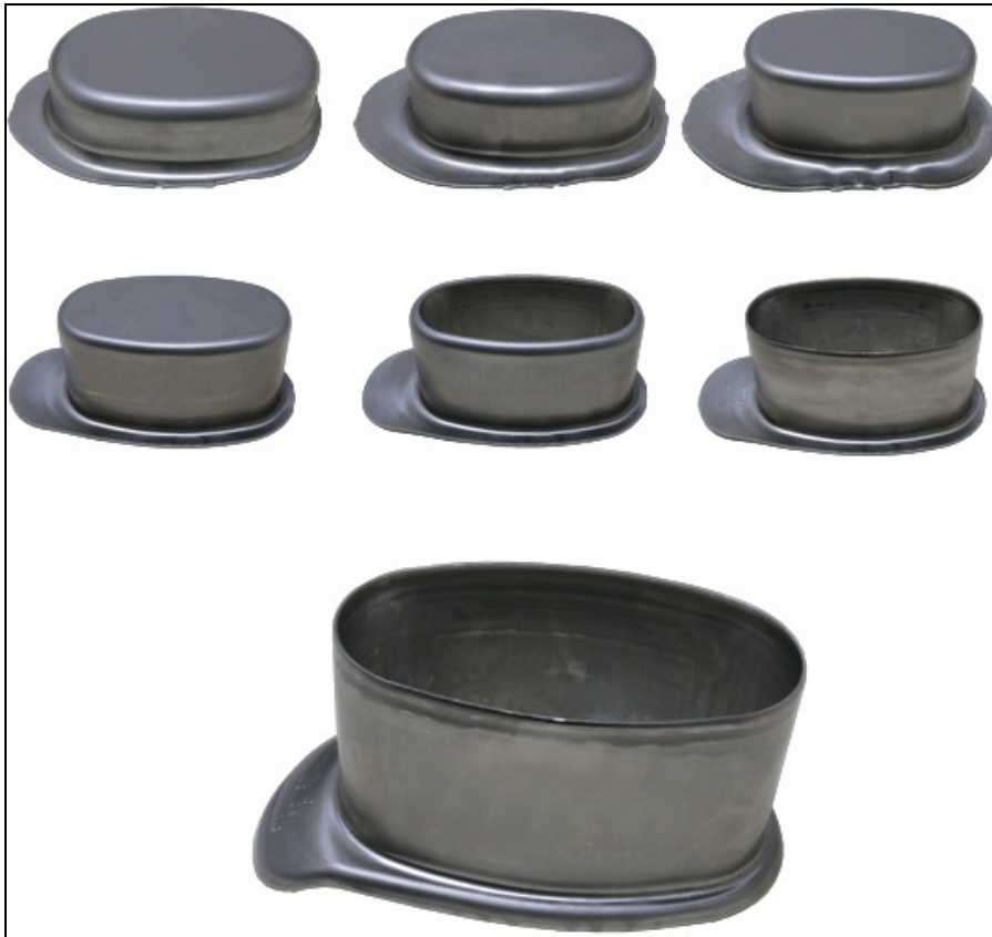
Abbildung 23: Katalysatorträger mit integriertem Zwischentrichter Quelle: Fiuka GmbH
