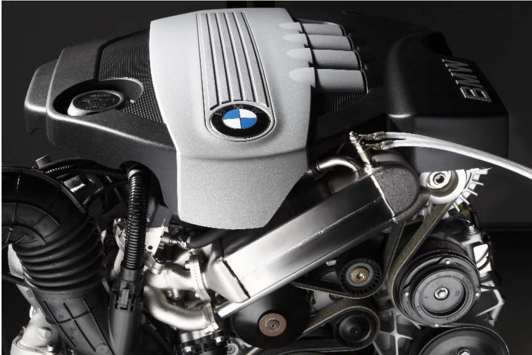
Abbildung 13: AGR Wärmetauscher am Motor angebaut mit elektrischer Durchführung
