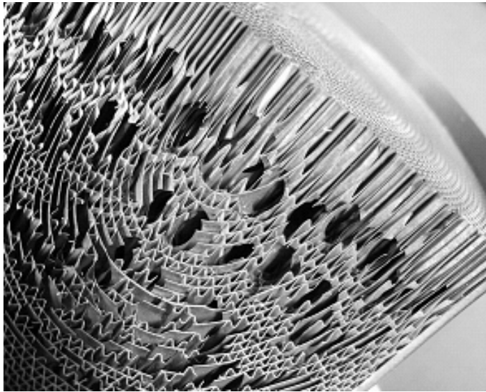
Abbildung 8: PE-Struktur mit Kavernenbildung
