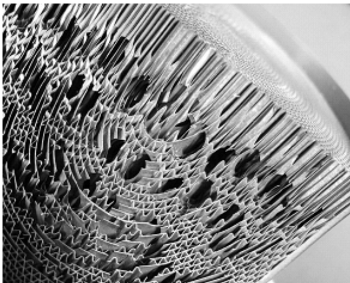
Abbildung 12: PE-Struktur mit Kavernenbildung PE structure with “caves”
