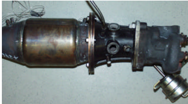
Abb.7: Aufbau des Abgassystems nach Turbolader
