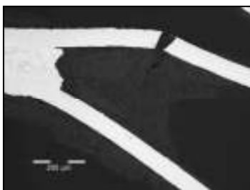
Abbildung 6. mechanisch induzierter Bruch (Schwingungsbruch)
