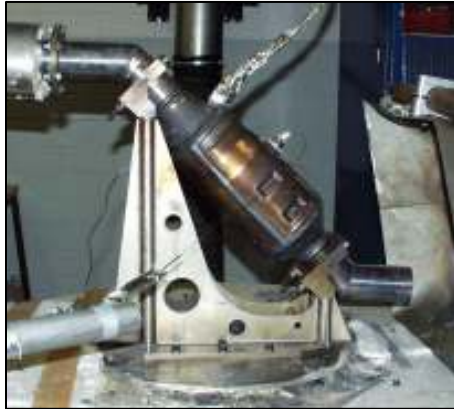
Abbildung 5. Aufbau Komponentenprüfstand und Key Life Time Testbedingungen
