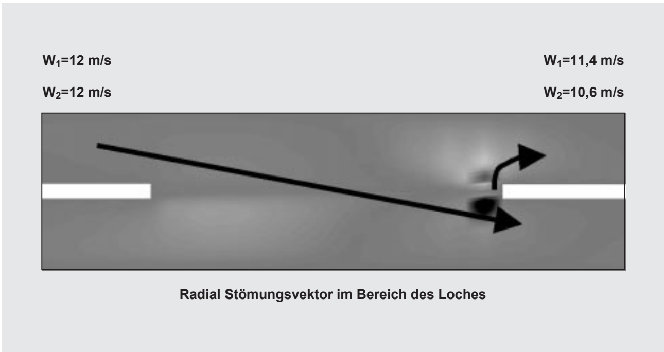
Abb. 7: Radialer Strömungsausgleich durch PE-Design
